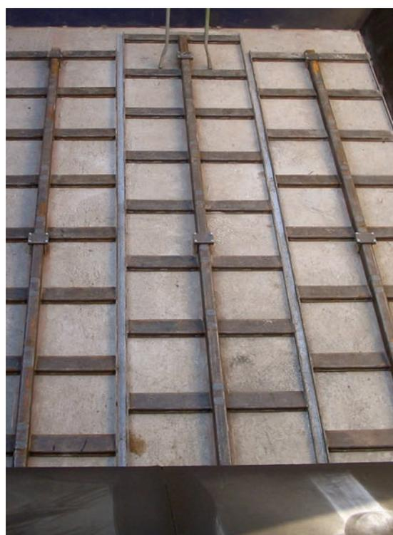
*Struttura: fondo silo e rastrelli in carpenteria metallica*
