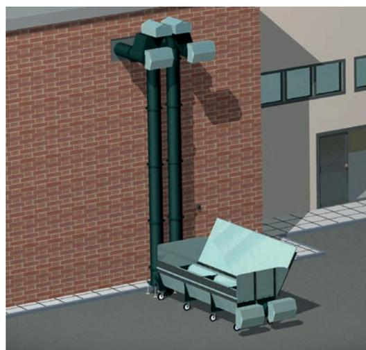
Schema Generatore di calore - Silo - Sistema di sollevamento
