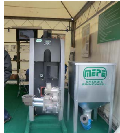
Una caldaia, un silo per il pellet ed un bruciatore da professionisti. Bello poterli mettere in evidenza.
